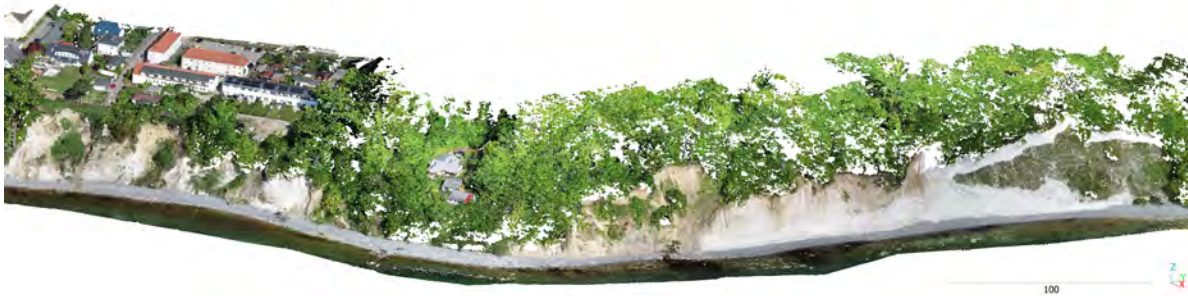
Abb. 17: Kliffprofil zwischen Sassnitz Wedding und Piratenschlucht, berechnet als Szene einer temporalen Punktwolke basierend auf Befliegungsdaten mittels Drohne. Durch Verschneidung verschiedener Szenen können multitemporale, koregistrierte Punktwolken als Grundlage für Veränderungsdetektionen und Strukturanalysen von Kliffabschnitten photogrammetrisch abgeleitet werden.
