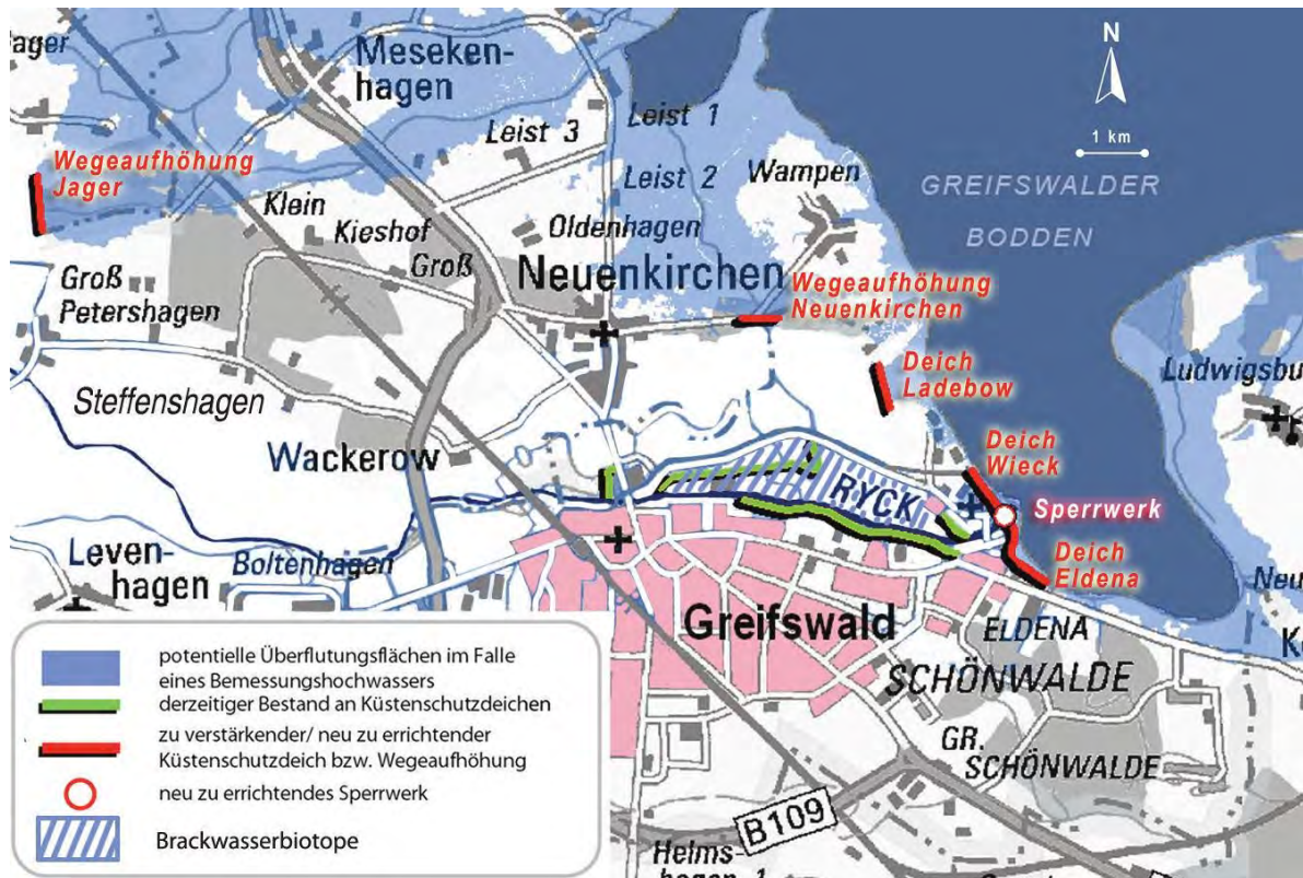
Abb. 8: Übersichtsplan zum Sturmflutschutz. © STALU VP 2011
