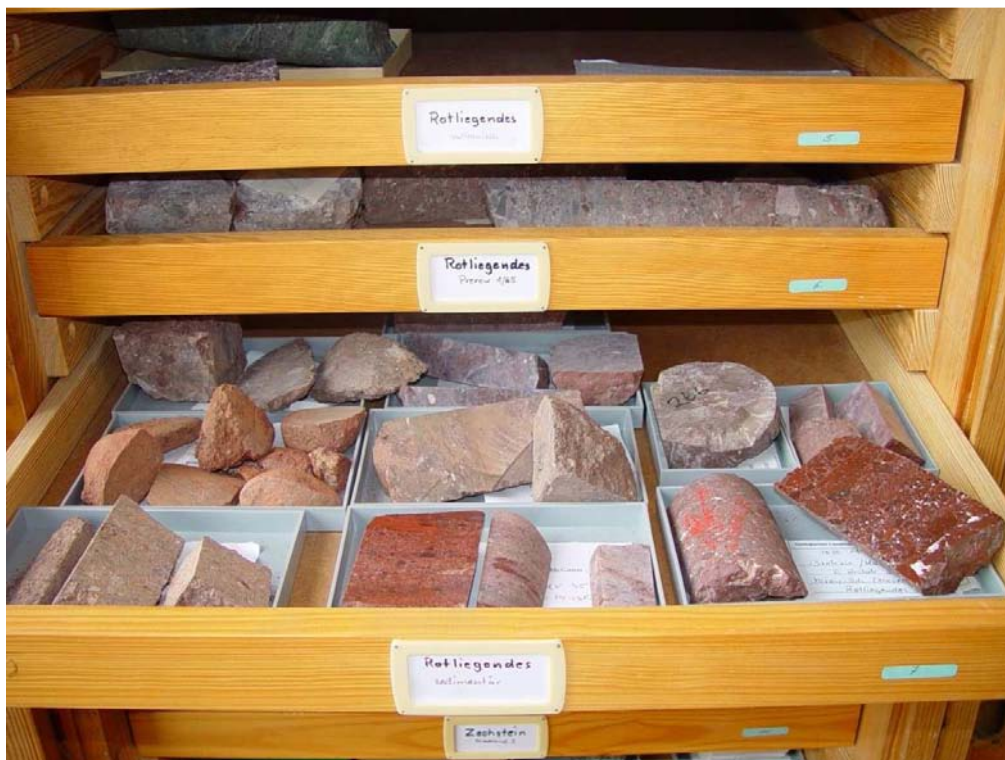
Abb. 33: Blick in die Probensammlung mit Bohrproben aus dem Rotliegenden. (Foto: K. Obst, 2006)
