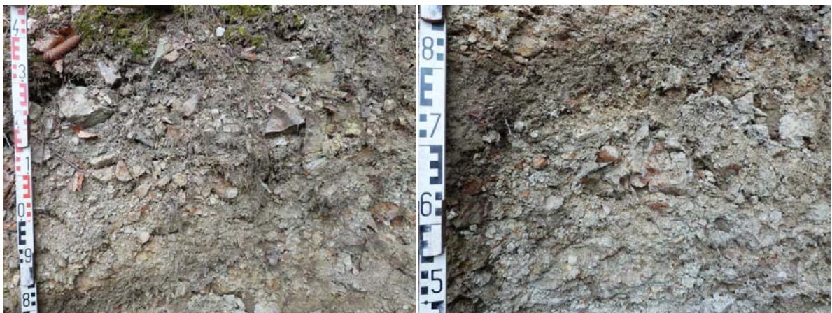
Abb. 18: Im Aufschlussprofil Nr. 2 dominieren kalkfreie Ton-Schlufflinsen und Scherbelsteine aus dem Mittel-Eozän.
