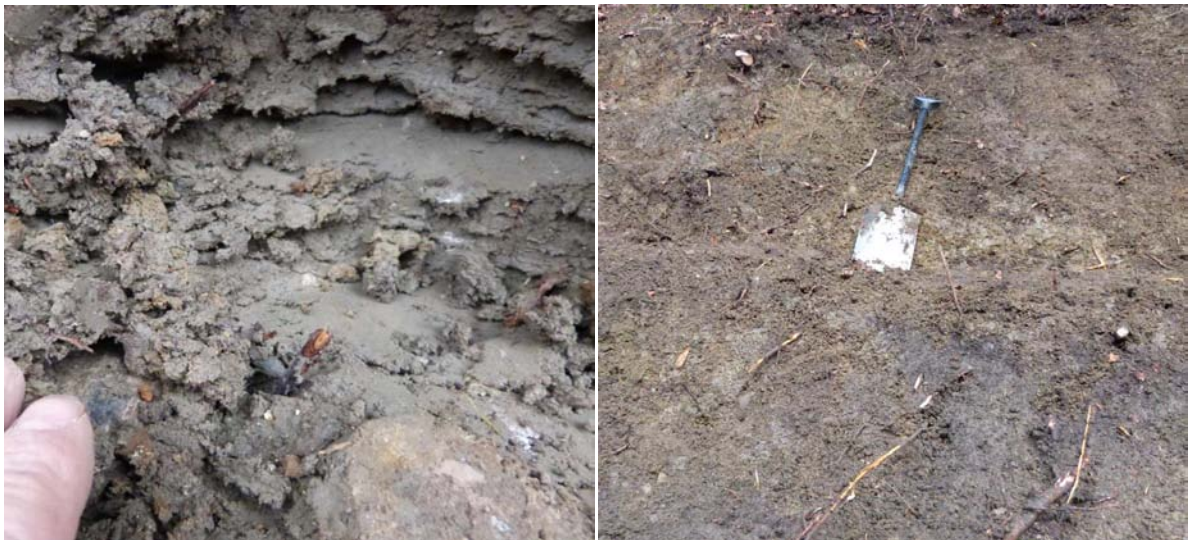
Abb. 19: Im Aufschlussprofil Nr. 3 dominieren tonreiche grünlichgraue Geschiebemergel mit einer Steinanreicherung (Bild links) und glazitektonisch umgelagerte, kalkfreie Ton- und Schluffpartien aus dem Eozän (Bild rechts).
