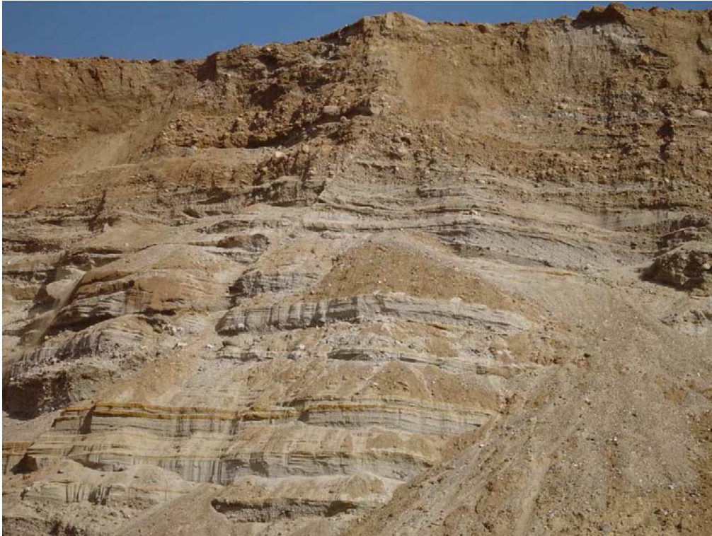
Abb. 27: Vorschüttsande mit eingeschalteten Kieslagen kennzeichnen die Nutzschrift unterhalb der 0,5 m mächtigen Abraumschicht im NE-Teil der Kiesgrube Kobrow. Der Anschnitt ist etwa 10 m hoch. (Foto: K. Obst, 2015)
